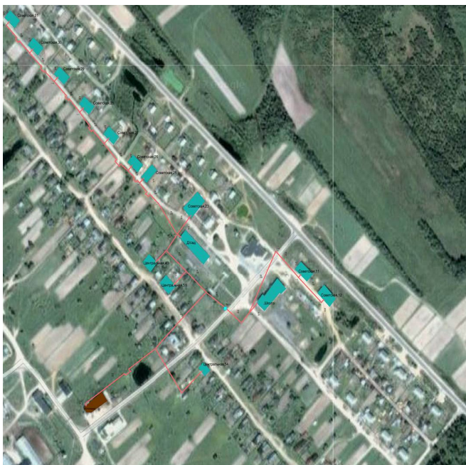
Схема сетей горячего водоснабжения от котельной д. Шевинская
