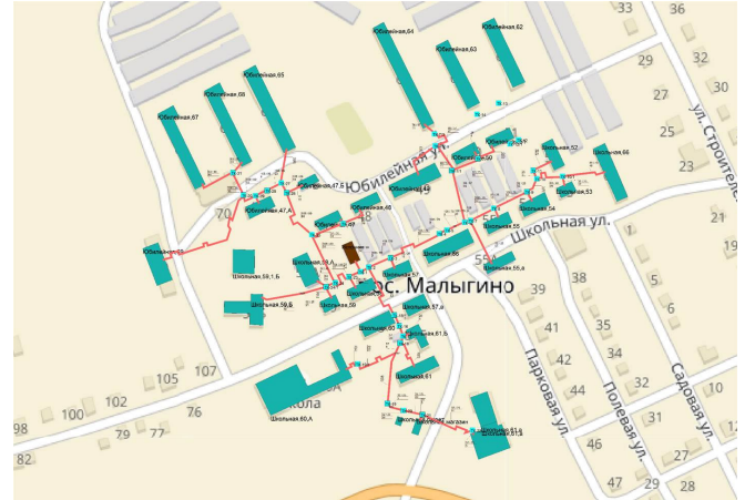
Схема сетей горячего водоснабжения от котельной п. Малыгино
