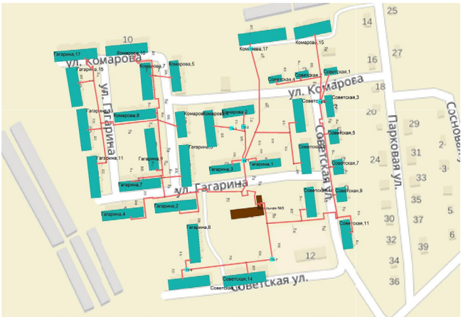
Схема тепловых сетей от котельной п. Мелехово, ул. Гагарина,2а
