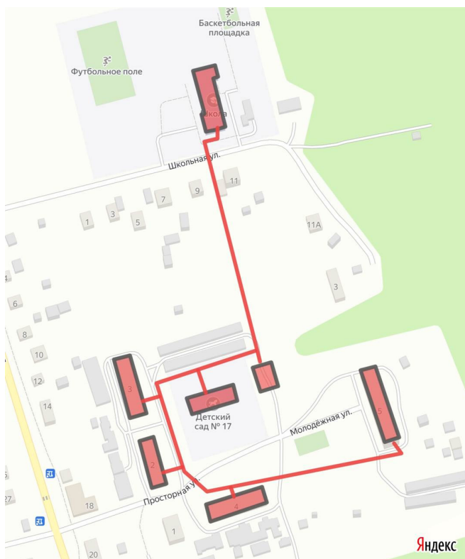
Схема сетей ГВС от котельной п. Мелехово, ул. Строительная
